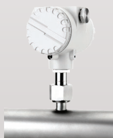
通过螺帽传感器头部可以进行旋转, 每次旋转幅度为90°
